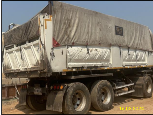
รูปที่ 2-4 การใช้ผ้าใบปิดคลุมรถบรรทุกและผูกมัดวัสดุอุปกรณ์รถบรรทุกขณะขนย้าย (ต่อ)
