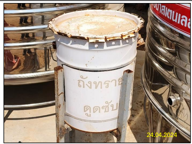
รูปที่ 2-12 การจัดเตรียมภาคเก็บและรองรับน้ำมัน พร้อมวัสดุดูดซับ (ต่อ)
