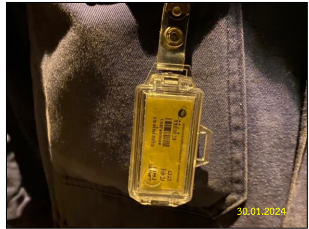
ตรวจสอบและติด Film Badge หรือ แผ่นวัดรังสีชนิด Optically Stimulated Luminescence (OSL) (ต่อ)
