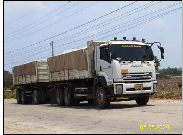
รูปที่ 2-4 การใช้ผ้าใบปิดคลุมรถบรรทุกและผูกมัดวัสดุอุปกรณ์รถบรรทุกขณะขนย้าย (ต่อ)
