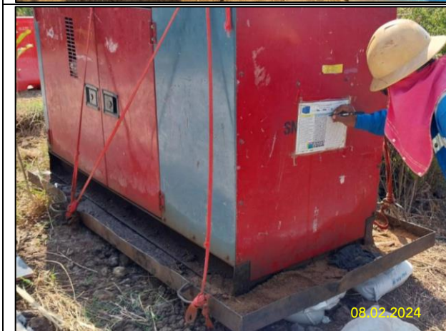
รูปที่ 2-12 การจัดเตรียมถาดเก็บและรองรับน้ำมัน พร้อมวัสดุดูดซับ
