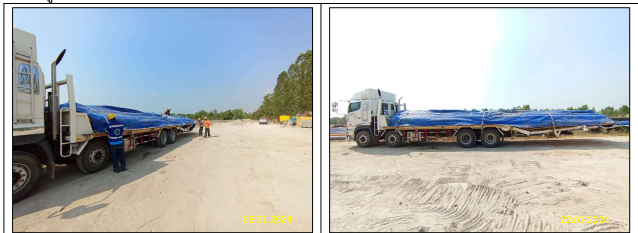
รูปที่ 2-4 การใช้ผ้าใบปิดคลุมรถบรรทุกและผูกมัดวัสดุอุปกรณ์รถบรรทุกขณะขนย้าย
